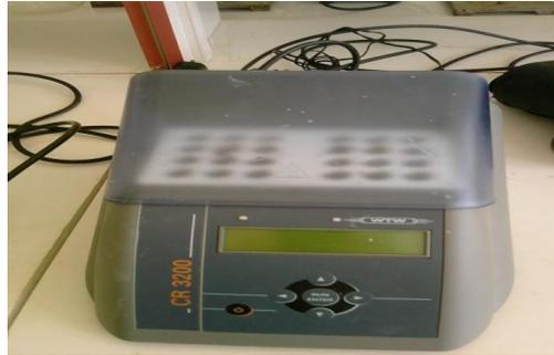
*Figure II .I.5. DCOmètre.*
