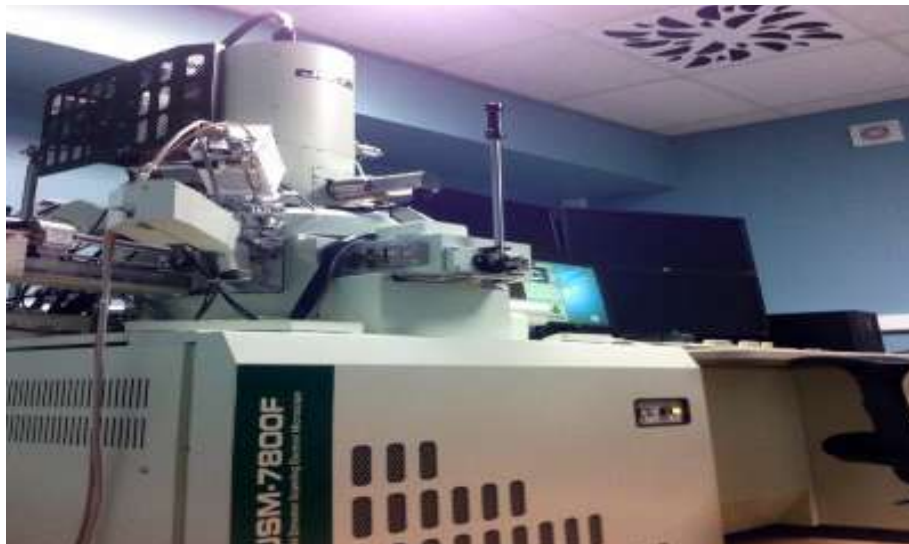
Figure. II.16. Microscope électronique à balayage avec canon à effet de champ MEB-FEG du laboratoire UMET.
