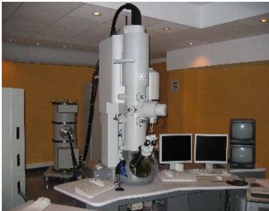
Figure. II.18. Microscope électronique en transmission de type FEI Tecnai G2 20 du laboratoire de recherche UMET.
