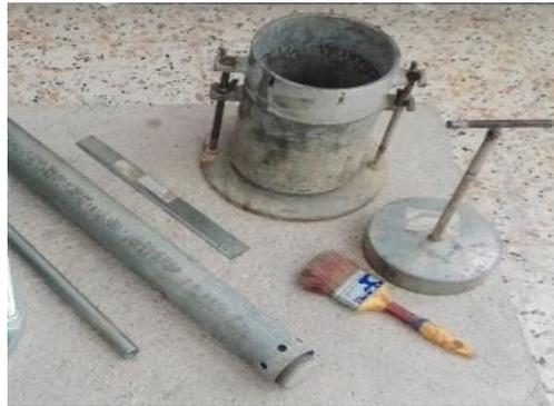
Figure III.1 : Moule CBR et accessoires de compactage Proctor modifié.
