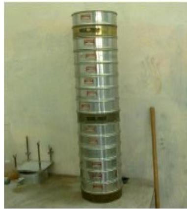
**Figure I.6 : Analyse granulométrique par tamisage.**
