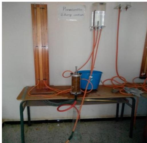
**Figure.III.10 : Perméamètre à charge constante.**
