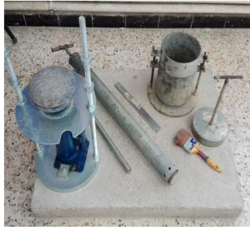
**Figure II.5 : Matériels utilisés pour l'essai Proctor modifié.**
