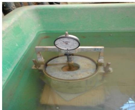
Figure III.3 : Comparateur sur éprouvette mise en immersion.
