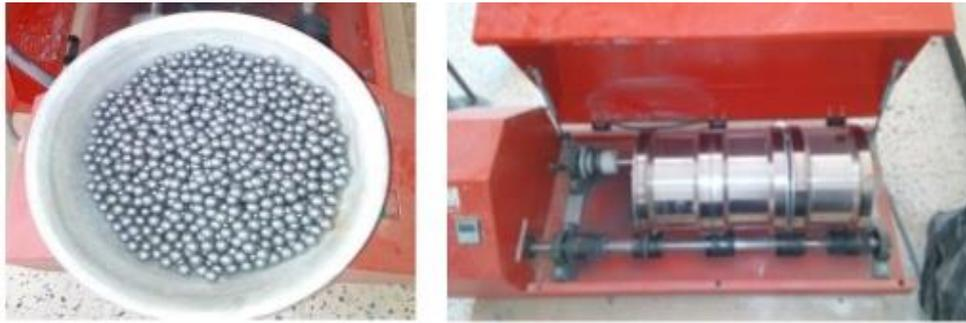
Figure III.7 :Machine d'essai Micro-Deval.
