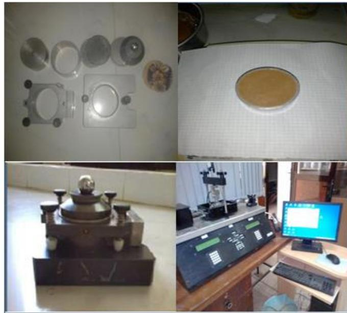
**Figure II.12 : Mode opératoire de l'essai de cisaillement à la boîte.**
