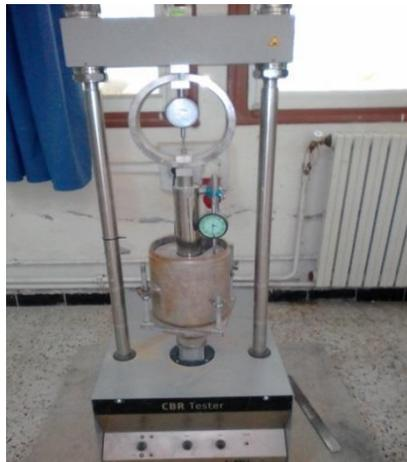
Figure III.2 : Presse à poinçonnement CBR.
