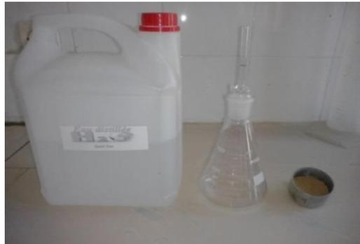
**Figure I.11 : Equipement de l'essai (pycnomètre).**
