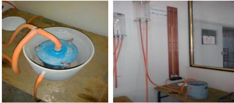
Figure.III.11 : Perméamètre à charge variable.
