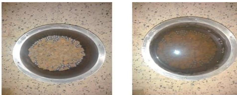
Figure III.8 : Mode opératoire d'essai micro-Deval.
