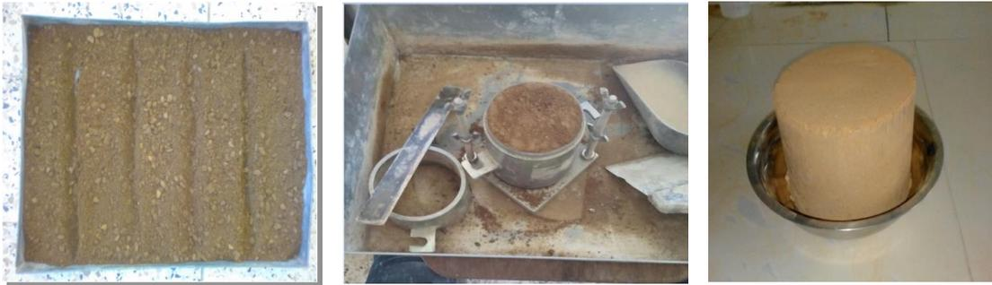
Figure II.6 : Matériel de confection des éprouvettes de l'essai Proctor modifié.
