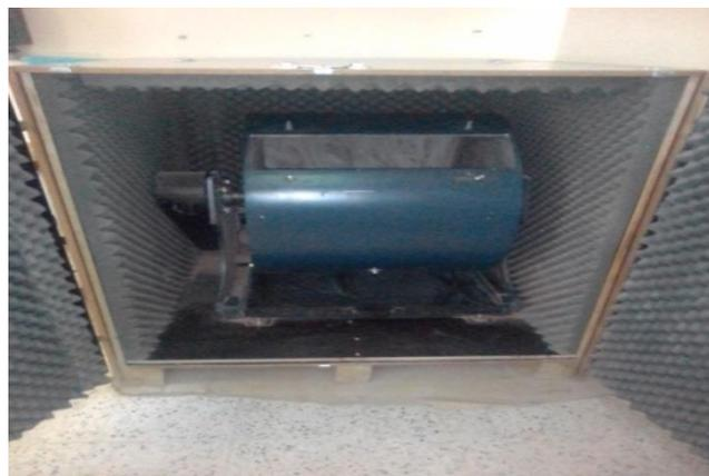
**Figure III.6 : Machine d'essai Los Angeles.**
