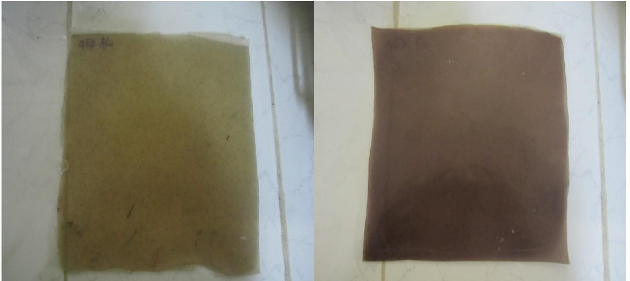
a) Plaque réalisée en PVC, additifs, et aluminium b) Plaque réalisée en PVC, additifs, et cuivre Figure IV.5. Plaques sous forme de carré ayant environ 25 cm de côté et 2 mm d'épaisseur.
