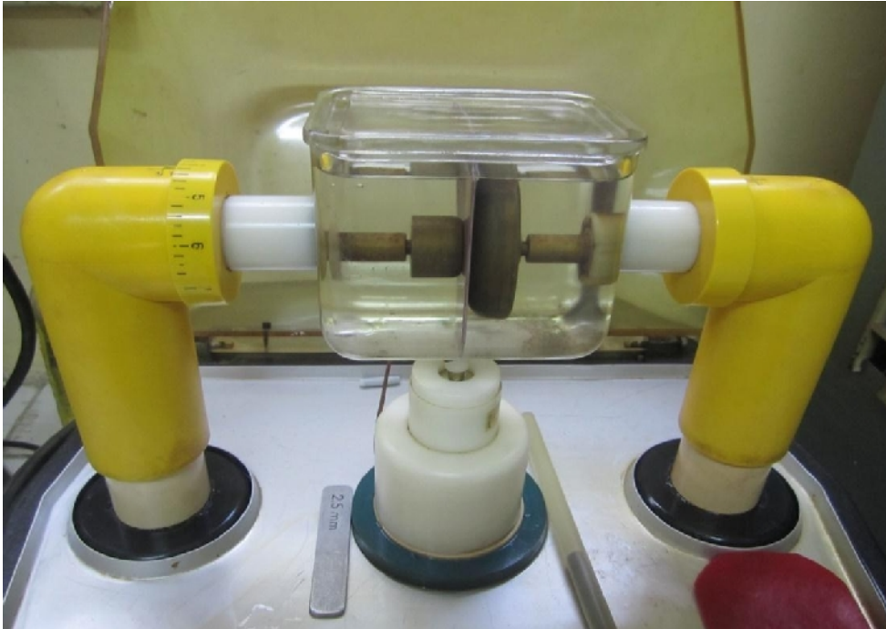
Figure IV.17. Eprouvette de l'isolant introduite entre les deux électrodes de haute tension.
