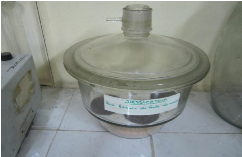
Figure IV.9. Dessiccateur et échantillons durant le conditionnement.
