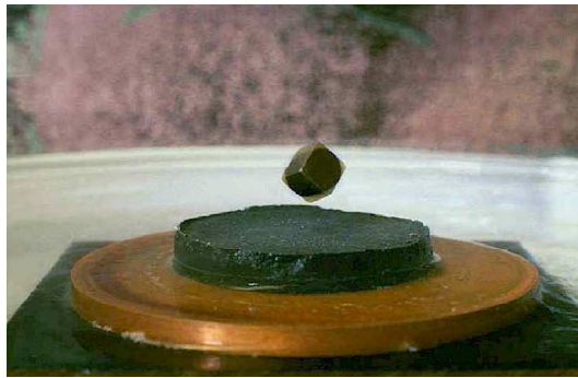
Figure III.2. Un aimant en lévitation au-dessus d'un disque supraconducteur.
