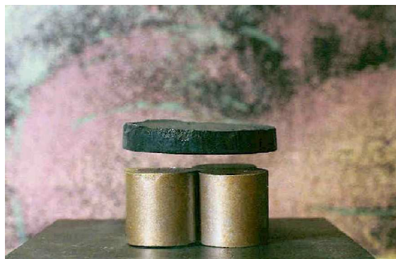
Figure III.3. Un disque supraconducteur en lévitation au-dessus d'aimants.
