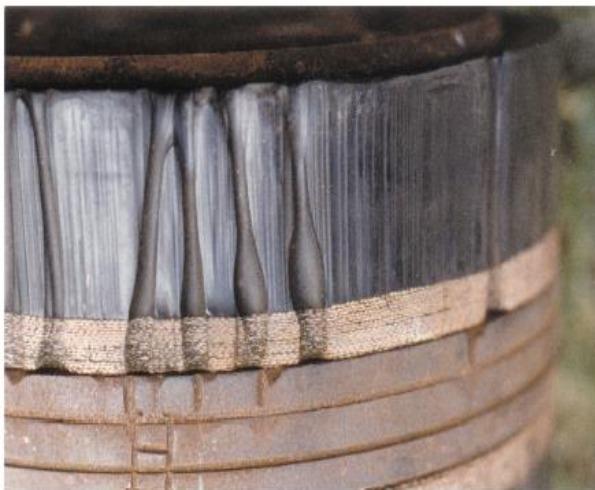
Figure III.12: Érosion par un fluide chargé inoxydable usée par érosion Piston de pompe véhiculant un fluide à base d'alumine
