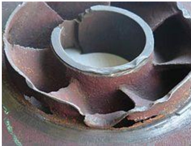
Figure III.14: impulseur de pompe centrifuge rongé par la cavitation.
