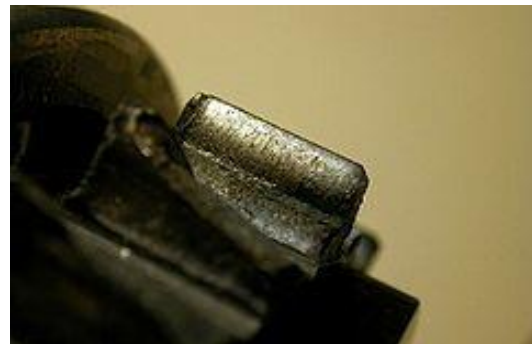
Figure III.5: Grippage sur une dent d'engrenage
