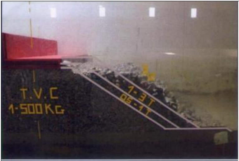
Figure IV.09 Vue du talus intérieur de la variante N°01 après essai
