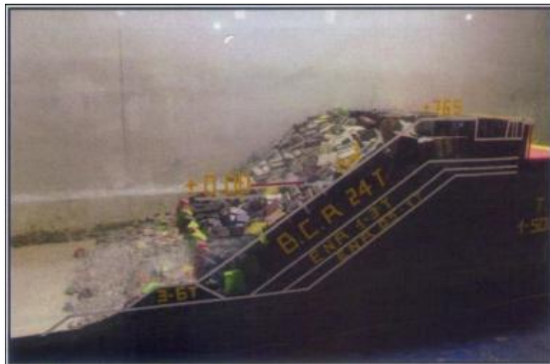
Figure IV.30 Vue du talus extérieur de la variante n°04 après l'essai
