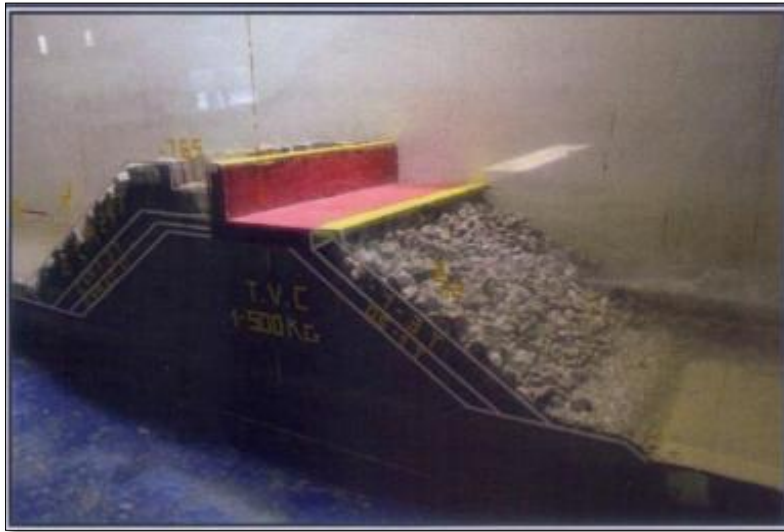
Figure IV.24 Vue du talus intérieur de la variante 03 après l'essai
