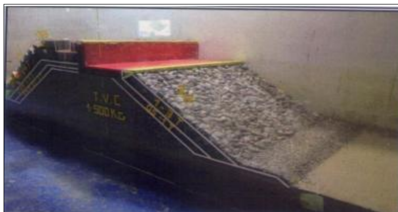
Figure IV.28 Vue du talus intérieure de la variante n°04 avant l'essai
