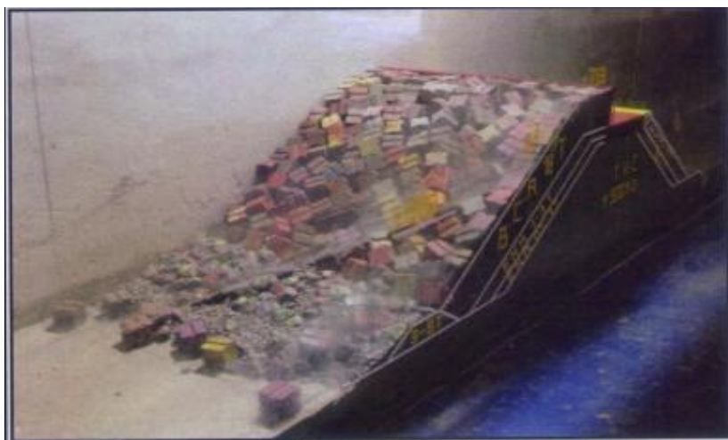
Figure IV.16 Vue du talus extérieur de la variante N°02 après l'essai.
