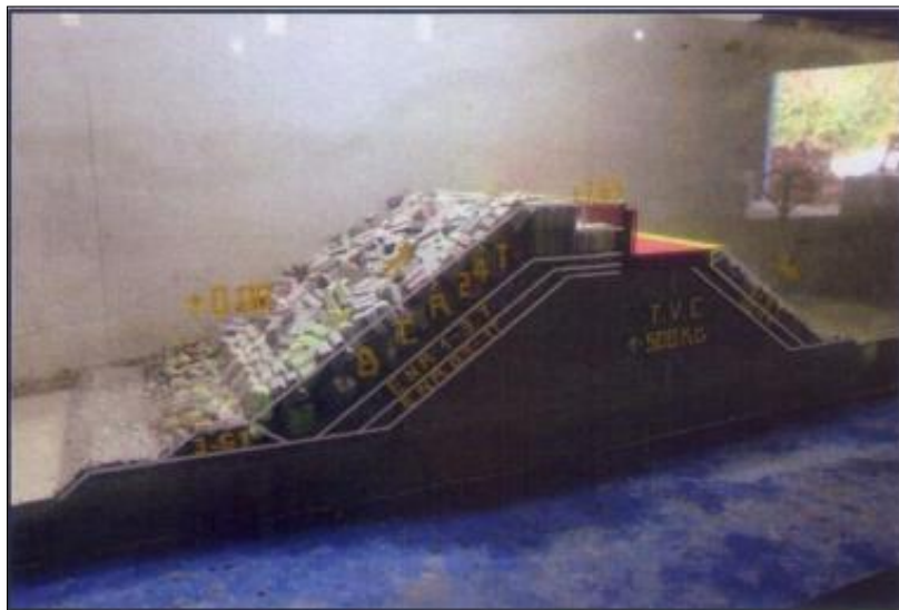
Figure IV.20 Vue du talus extérieur de la variante N°03 avant l'essai
