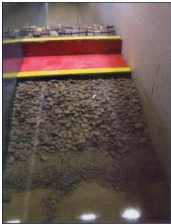
Figure IV.40 Vue du talus extérieur de la variante n°05 après l'essai
