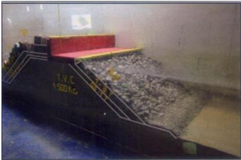
Figure IV.32 Vue du talus extérieur de la variante n°04 après l'essai
