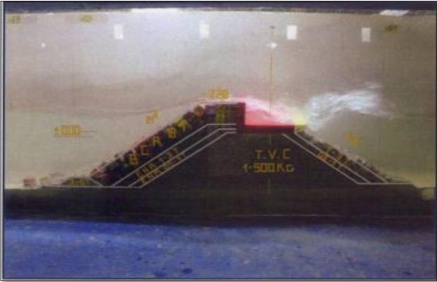
Figure IV.14 Vue de la variante N°02 durant l’essai de la houle biennale
