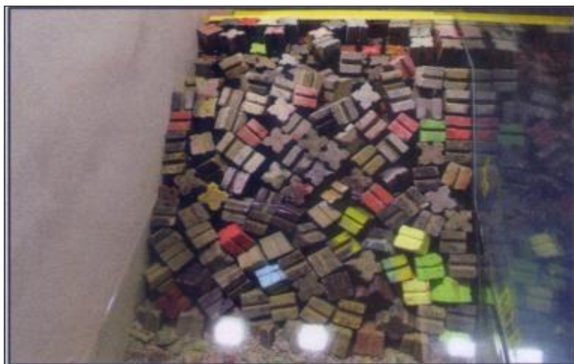
Figure IV.23 Vue de la carapace de la variante n°03 après l'essai
