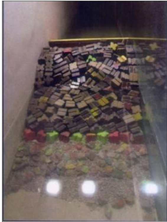
Figure IV.39 Vue du talus extérieur de la variante n°05 après l'essai
