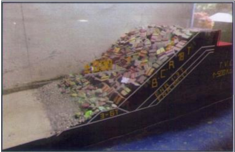
Figure IV.10 Vue du talus extérieur de la variante N°01 après essai
