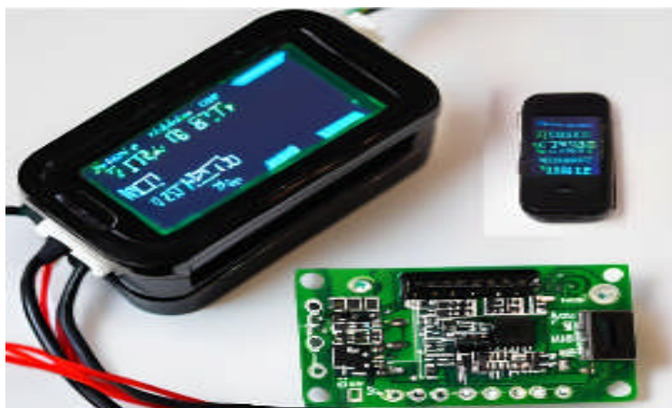
Figure II.7: Un oxymètre avec un microcontrôleur ATMEGA 328.
