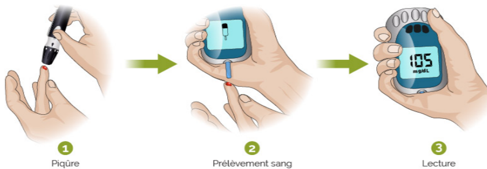
Figure I.4: Fonctionnement d'un glucomètre [34].
