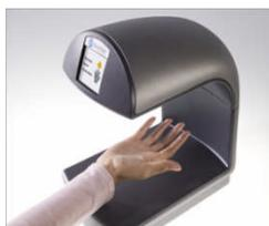
**Figure I.17 : appareil pour la reconnaissance des réseaux veineux de la main**
