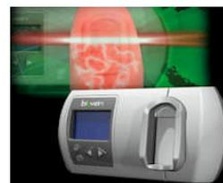
**Figure I.18 : appareil pour la reconnaissance des réseaux veineux du doigt**
