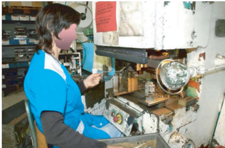
Figure II.11 : Exemple de manutention des pièces sur outil de reprise.
