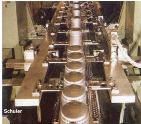
Figure II.12 : Outil avec système transfert sur presse
