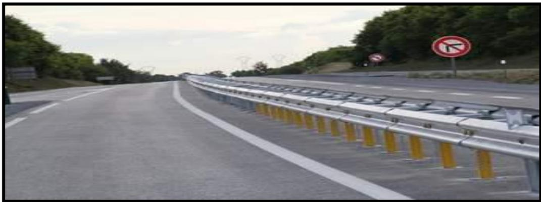
***Figure X-12 : photo d'une glissière de sécurité***
