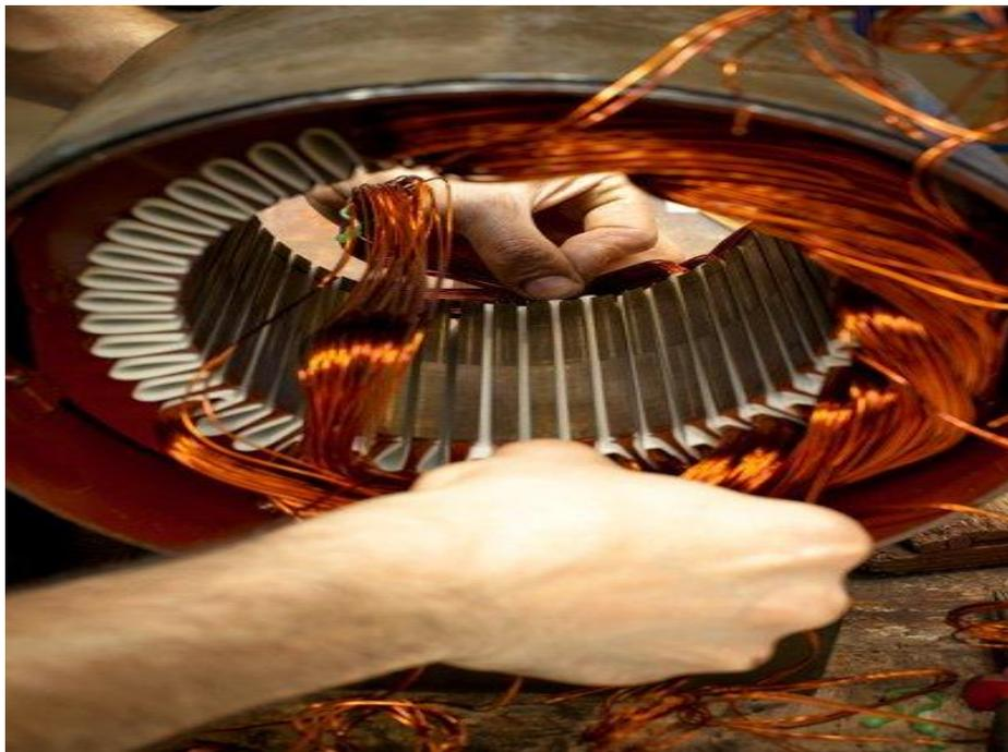
**Figure. I.9.** Bobinage d'une machine électrique
