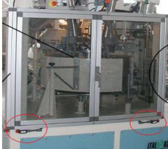
Figure I.15 : Interrupteur de position sur les portes.
