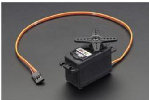
Figure IV.3 : Présentation d'un servomoteur
