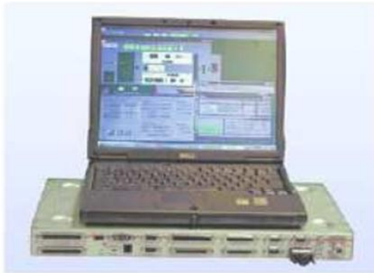
Fig.32. Coffret principal IDU et poste d'exploitation
