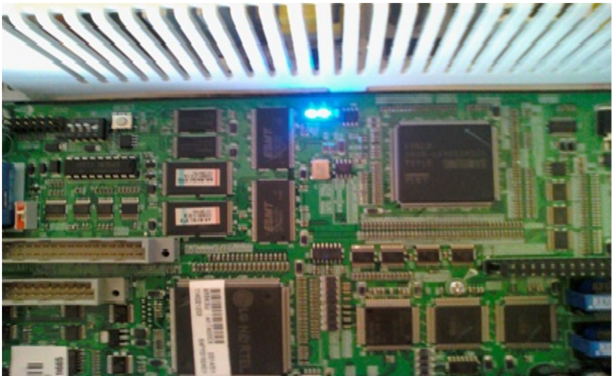
Fig. 65. Positionnement des switch sur la MBU
