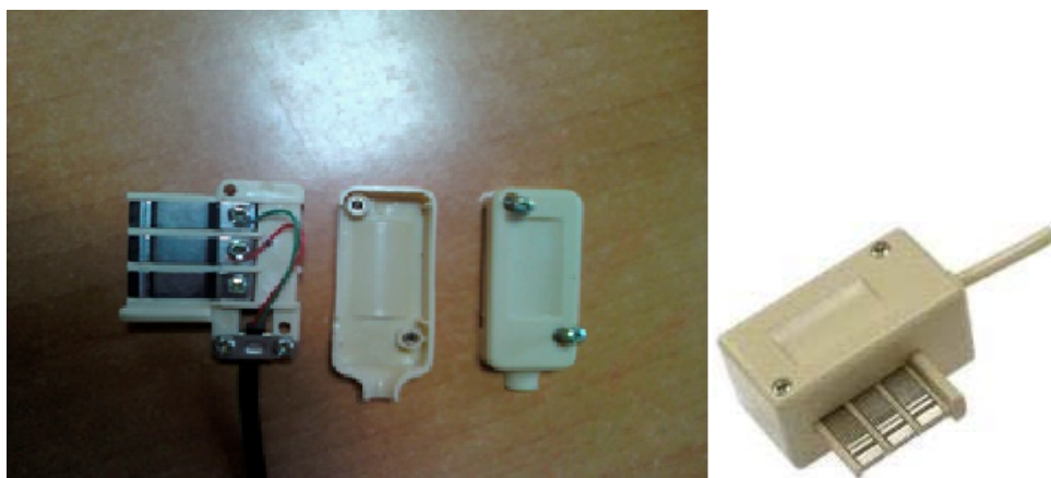
Fig. 59. Branchement des connecteurs Fiches males
