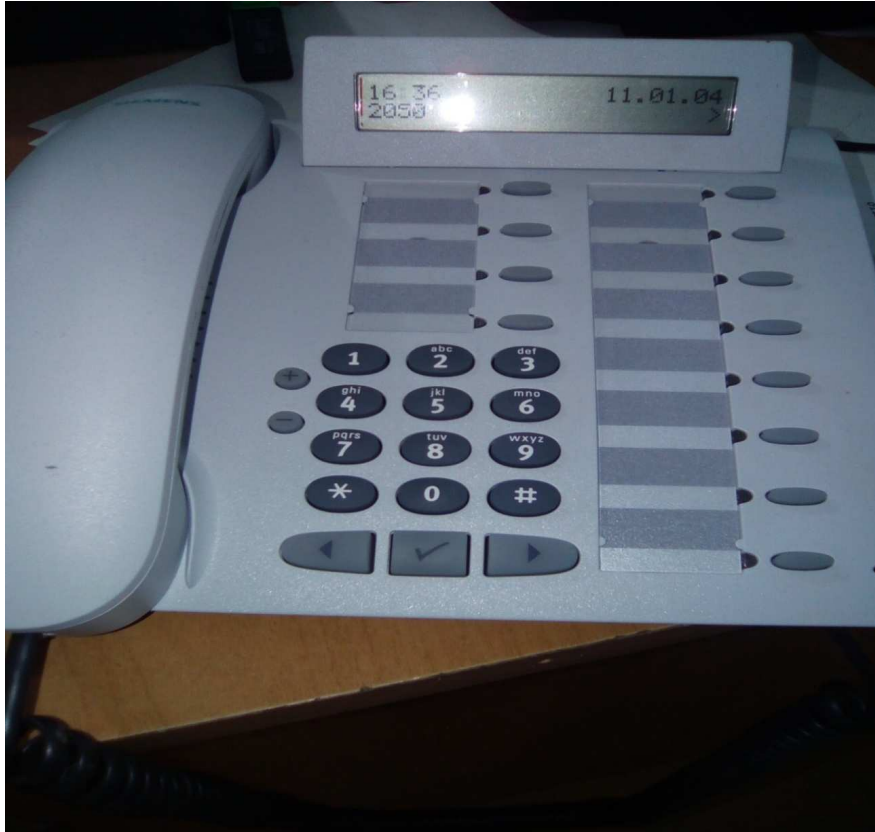
Figure III.30. Affichage du numéro sur le poste IP
