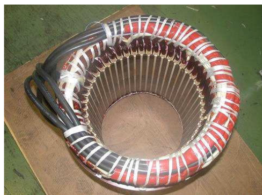
Figure (II.17) : Bobinage réparti pour une machine à flux radial [23].
