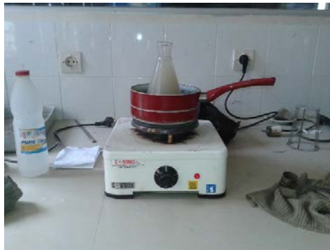
Figure 51: élimination des bulles d'air par ébullition à la plaque chauffante.
