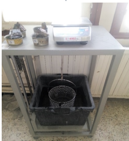
Figure 47: préparation de quatre échantillons de schiste dans le panier de la pesée hydrostatique.
