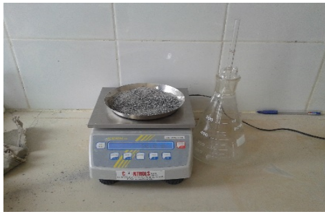
Figure 49: pesé de 50g du schiste passant le tamis 2mm.
