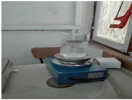
Figure 44: préparation de la solution à l'aide d'un agitateur électrique
