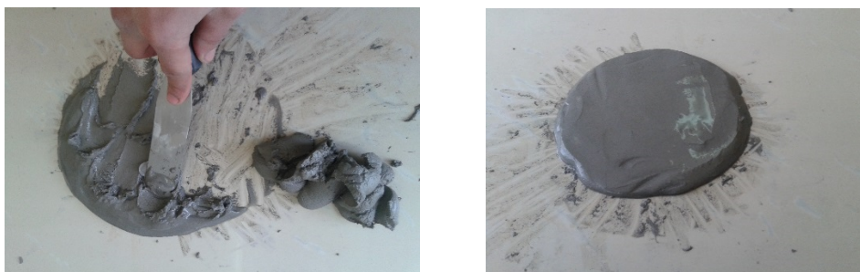
Figure 52: préparation de l'échantillon pour réaliser les limites d'Atterberg.
