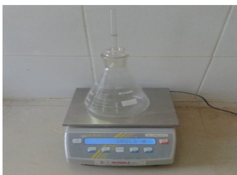
Figure 48: pesé du pycnomètre à vide M_1 .
