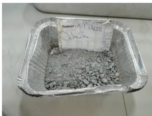
Figure 193: préparation de l'échantillon pour l'essai avant traitement.
