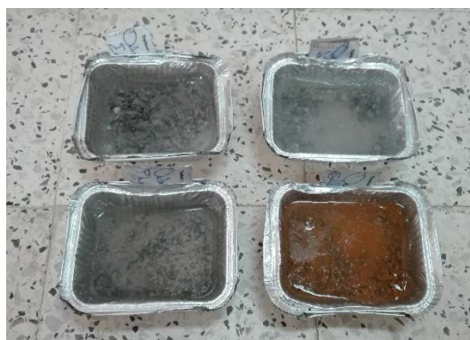
Figure 194: préparation des échantillons pour réaliser quatre essais œdométriques.
