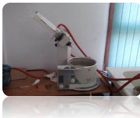
Fig.18 : Evaporateur rotatif de type HEIDOLPH.
