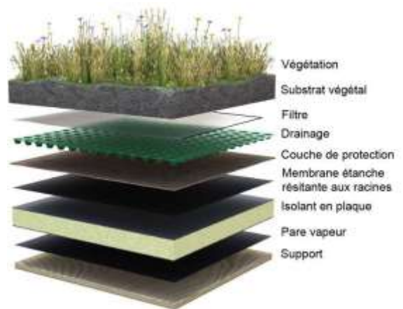
Figure 221 : Composante de la toiture végétalisée Source : toiture-vegetalisee.architecteo.com
