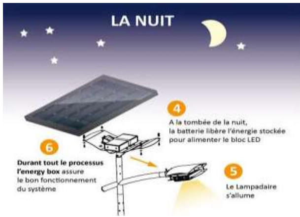
Figure 225: Fonctionnement du lampadaire solaire à la tombée de la nuit. Source : Fonroche éclairage
