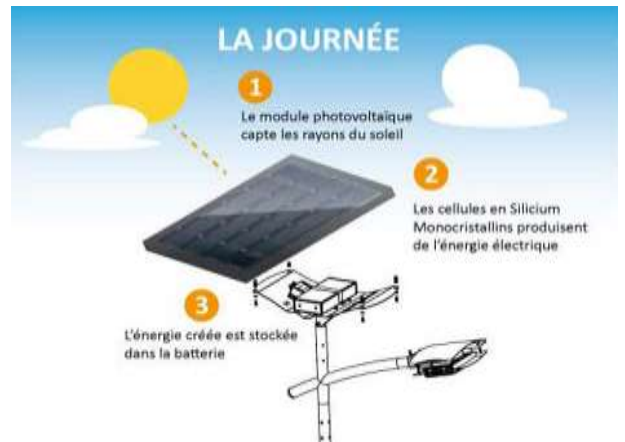
Figure 226 : Fonctionnement du lampadaire solaire durant la journée. Source : Fonroche éclairage
