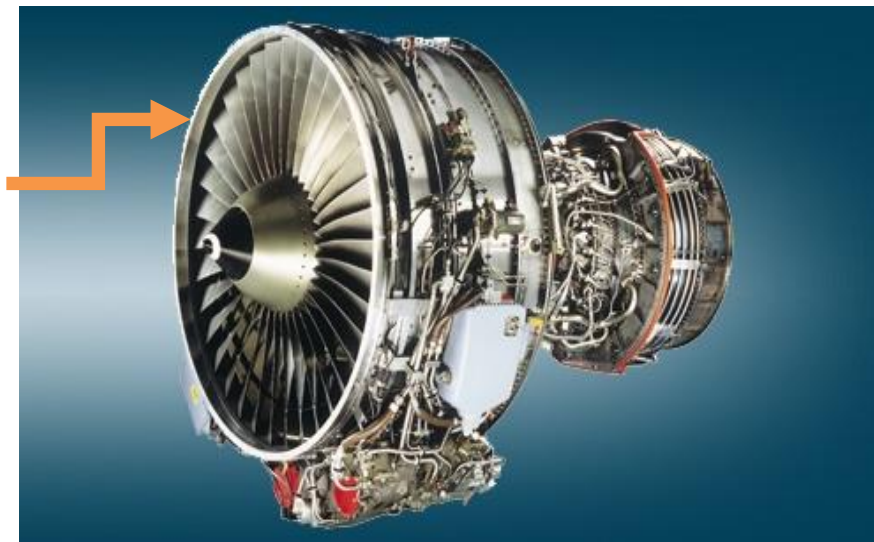
Figure. I.3. La soufflante d'un CF6-80 E1.
