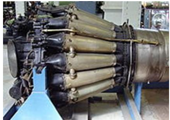
.Figure.I.8. Chambers de combustion
