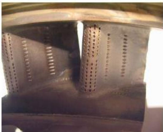
Figure III.2: Aube refroidie par film
